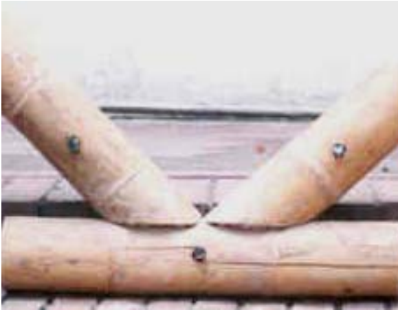
Foto No11 y 12. Falla por corte paralelo a las fibras. (tomado de las referencias No 2 y 3 )
