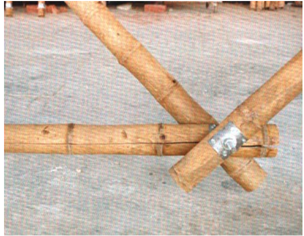
Foto No11 y 12. Falla por corte paralelo a las fibras. (tomado de las referencias No 2 y 3 )
