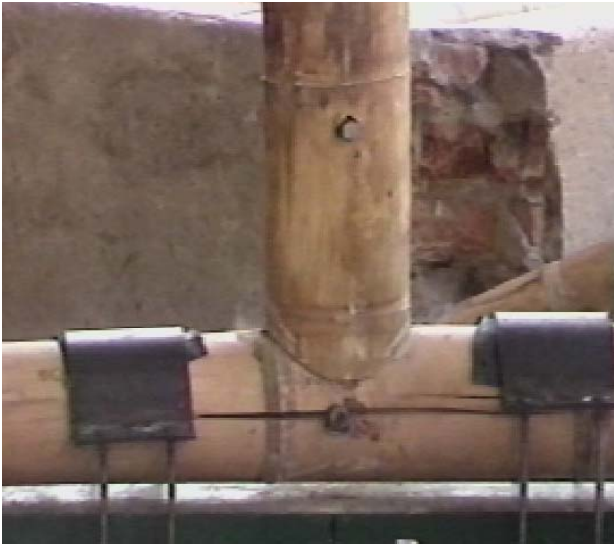
Foto No9. Falla por tensión perpendicular a las fibras. (tomado de la referencia No3 )
