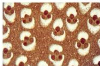
Fig 28 - Visão microscópica de uma seção transversal de bambu
