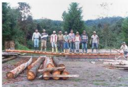
Fig 34 – Teste experimental de flexão
