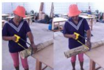
Figs 47 e 48 – Corte de entrenó com serra de arco
