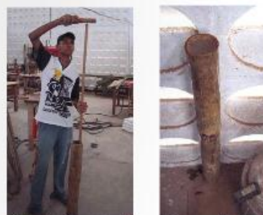
Fig. 40 e 41 – perfurando os entronos e peça de colmo preenchida com solução preservativa.
