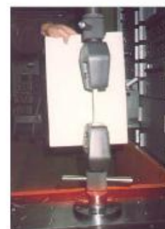
Fig 32 - Teste de tração paralela às fibras
