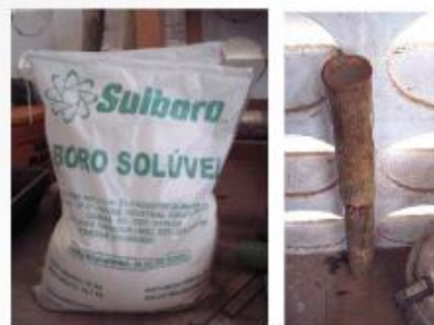
Fig. 42 e 43 – Saco de octaborato solúvel e peça preenchida com solução preservativa
