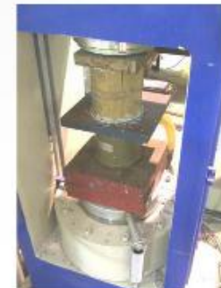
Fig 33 - Teste de compressão paralela às fibras
