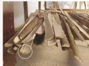
Figs 37 e 38 – Problema de utilizar o bambu antes de estar seco. Na primeira foto o bambu ainda úmido foi aplainado na face externa. Após alguns dias as ripas retas se curvaram, causado pelo processo natural de secagem.
