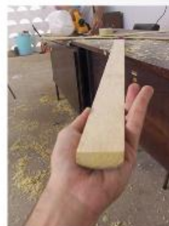
Figs 37 e 38 – Problema de utilizar o bambu antes de estar seco. Na primeira foto o bambu ainda úmido foi aplainado na face externa. Após alguns dias as ripas retas se curvaram, causado pelo processo natural de secagem.
