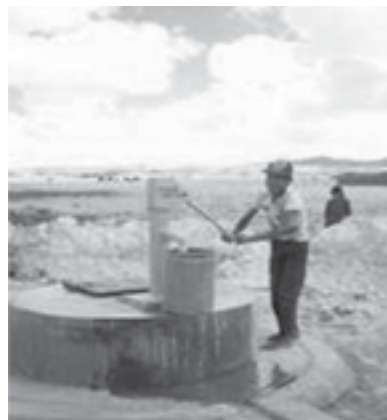
Operación de la bomba Heuser
