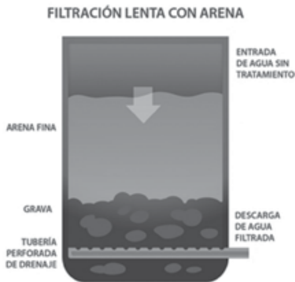
Figura J.9.3 Corte transversal de un filtro lento casero
