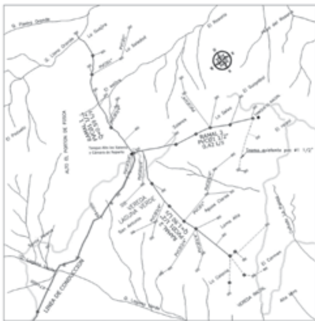
Figura J.2.7 Plano de ramales y redes de distribución
