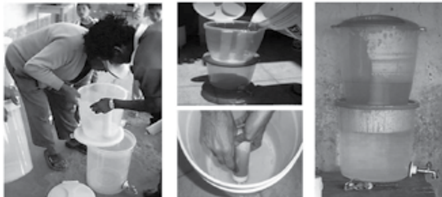
Filtros de vela cerámica de fabricación casera utilizando baldes comerciales de polietileno
