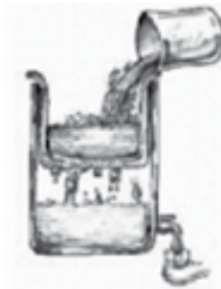
Corte transversal de un filtro de cerámica
