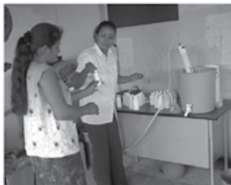
Generadores de cloro in situ fabricados en Guatemala
